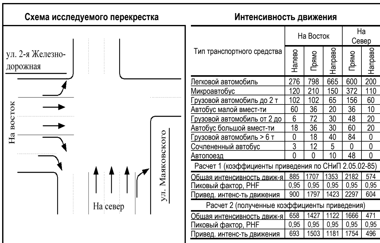
Рис. 4. Схема пересечения ул. 2-я Железнодорожная и ул. Маяковского в г. Иркутске и результаты расчета приведенной интенсивности движения при использовании различных коэффициентов приведения
