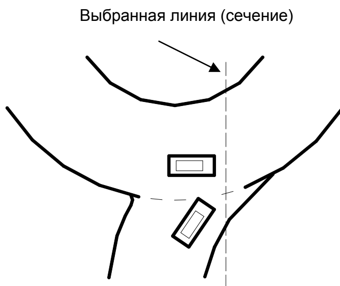
Рисунок 7 – Определение линии (сечения) по которой будут определяться моменты совершения обследуемых событий (например, прохождение переднего бампера транспортного средства над данной линией)
