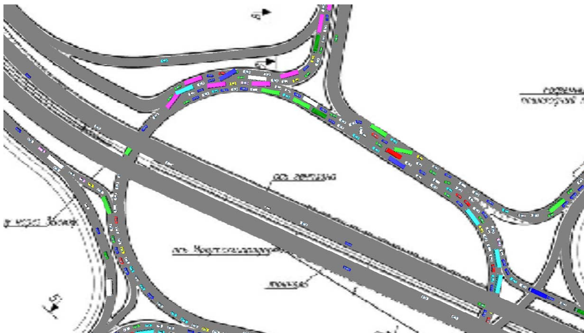
РИС. 2 – Фрагмент моделирования одного из вариантов развязки (см рис. 3) в программе микромоделирования VISSIM для случая, когда использованы интенсивности движения, спрогнозированные на 2020 г.
