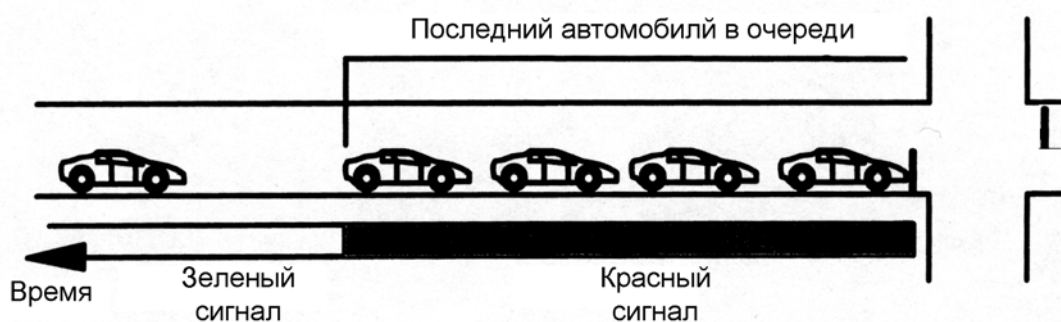
Рис.2. Иллюстрация определения исследователем последнего автомобиля в очереди, характеризующего момент окончания интенсивности потока насыщения
