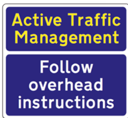
Рис. 1. Дорожный знак «Активное управление движением» («Active Traffic Management», Англия). Под активным управлением понимается совместное использование временных ограничений скорости, разрешения движения по обочине и светофорного регулирования на рампах развязок
